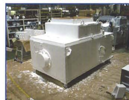
使用エネルギーのコストダウン 電気炉の表面温度が約30%下降
